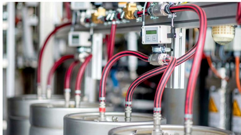
Elektrolyutrustning för tillverkning av vätgas hos det tyska energibolaget EWE. Foto: Hauke-Christian Dittrich/AP
